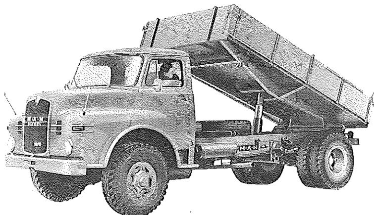
Diesel-Motor · 6 Zylinder · 4-Takt · 172 PS bei 2200 U/min
